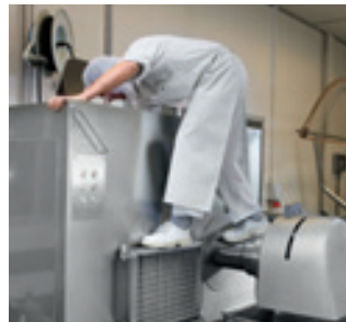
Das ist verboten. Aber: Klappt man die Trittfläche herunter, schaltet die Maschine ab. Der Auftritt ist mit dem Antrieb elektrisch verriegelt.
